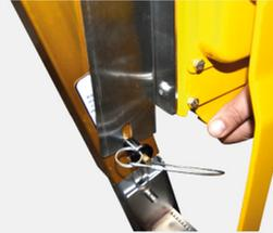
**2** Ubique la parte inferior del winche, revise la abertura en la base y móntela sobre el pin de seguridad previamente cuadrado.
