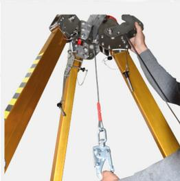
**7** Progresivamente, suelte el cable halándolo del extremo del cable, recuerde que el cable debe estar guiado por la puela.
