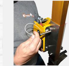
**3** Deben coincidir los orificios superiores (winche - pata trípode) para pasar el pin de seguridad y asegurar el winche a la pata del trípode
