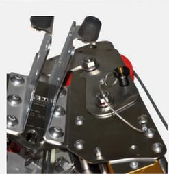
**8** Al momento de terminar con la ubicación del cable sobre la puela asegure el protector con el pin de seguridad
