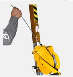
**5** Hale el cable del extremo del gancho y suelte el cable con la palanca correspondiente ubicada en el winche
