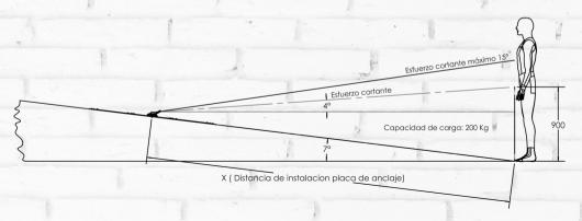
Esta determinada por la capacidad de carga del anclaje y el grado de inclinación de la cubierta. Este anclaje esta recomendado para ser instalado en cubiertas con pendientes comprendida entre el 7 a 12% (4° a 7°).
